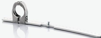
Die Fuba DAZ 104 ist eine Multifeed-Halterung für die größtmögliche Flexibilität beim Empfang von Satelliten-TV. Mit der Multifeed-Halterung lässt sich die Parabolantenne im Handumdrehen um bis zu drei LNBs erweitern und ermöglicht den Empfang von bis zu vier Satelliten mit nur einer Antenne. Durch die ausführliche und praxisnahe Installationsanleitung geht die Montage leicht von der Hand.
