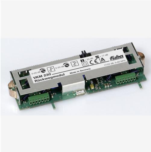
Das Fuba VKM 230 Rückweg-Modul dient der flexiblen und einfachen Konfiguration des Rückweges der Verstärker VHD 300 und VHD 380. Es verfügt über zwei Diplexfilter und einen Rückwegverstärker. Die Dämpfung und Entzerrung im Ausgang (des Rückwegverstärkers) ist variabel.
