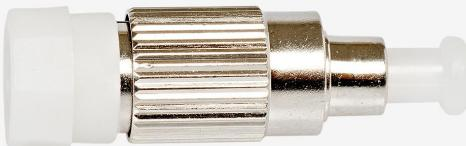
Das Fuba ODG 020 ist ein optisches Dämpfungsglied mit 20 dB Dämpfung und FC/PC-Stecker auf FC/PC-Kupplung. Das Dämpfungsglied wird benötigt um die ankommende Lichteistung in einer optischen Verteilung an die Eingangsempfindlichkeit der Rückumsetzer anzupassen.
