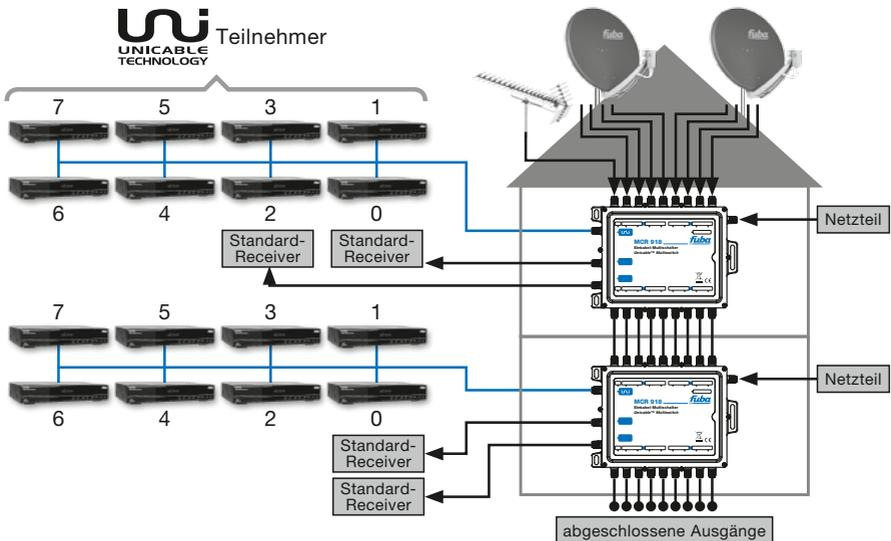
Verbinden Sie die Kabel von den Quattro-LNBs mit den Eingangsanschlüssen
