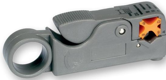
2. Zur Montage der Push-On F-Stecker auf die Kabeltypen Fuba GKA 720, 725, 730 und 300 muss der Kabelhaltereinsatz auf die **Nummer 9** (Bild 1) eingestellt werden. Dann werden die beiden Klingen mit Hilfe der beiden Innensechskantschrauben unterhalb des Abisolierwerkzeugs justiert. Wenn alle Einstellungen für die gewählte Kabeltype erfolgt sind, können die neuen Push-On F-Stecker schnell und sicher installiert werden.
