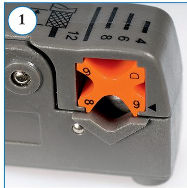
3. Kabelmantel und Innenleiter mit dem Doppel-Abisolierwerkzeug Fuba OVZ 115 abisolieren, das Masseflecht nach hinten umlegen (Bild 2).
