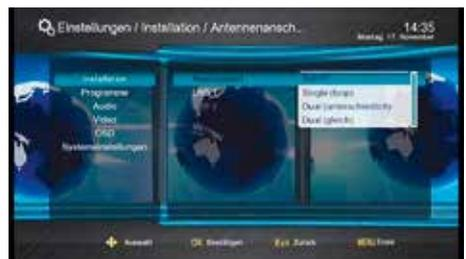
Die Auswahl der Anschlussart „Sat>IP“ im Menü „Einstellungen/Installation/Antennenanschluss“ ist Voraussetzung um den ODS 400 als SAT>IP-Receiver zu nutzen.
