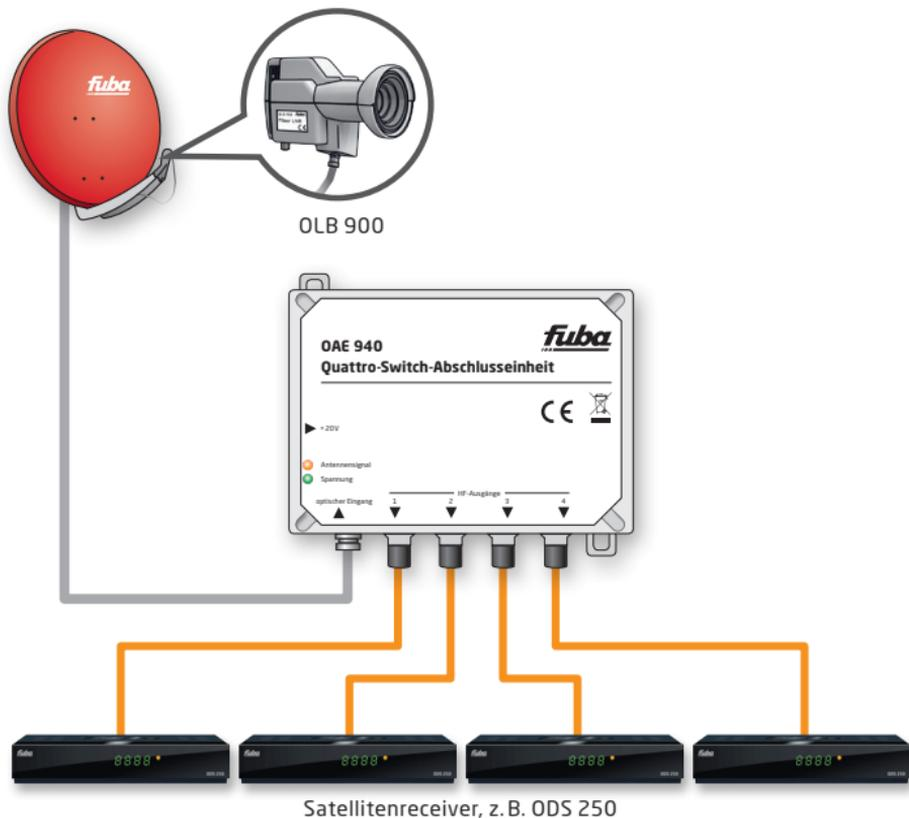
Die Abschlusseinheit wird von den angeschlossenen Receivern oder von dem optional erhältlichen Netzteil Fuba OKN 117 mit Spannung versorgt.
