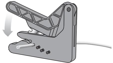
Jede Schneideöffnung des Messers sollte nur ein einziges Mal verwendet werden, da es durch die Kunststofffasern und die Kunststoffummantelung zu winzigen Beschädigungen des Messers kommt. Unsauber abgeschnittene Kabelenden können zu einer Verringerung der maximal möglichen Kabellänge bzw. zu einer Verringerung der Datenübertragungsraten führen.
