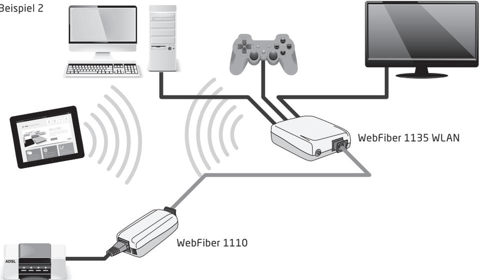
Für die Einspeisung des Internetsignals vom Router ins Netzwerk wird ein Adapter benötigt und für den Anschluss eines oder mehrerer Geräte wie Computer, TV-Gerät oder NAS-Server wird ein weiterer Adapter benötigt. Verbunden werden diese Adapter mit einem Lichtleiter-Kabel.
