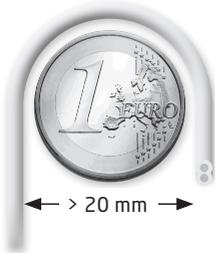
Die maximal zu nutzende Länge des Lichtleiter-Kabels hängt von der Anzahl der Biegungen, der Radien und der optimalen Licht-Einkopplung und -Auskopplung (Anschluss des Kabels an die Adapter) ab. Bei normaler Handhabung sind schon heute Übertragungsraten von 1 Gbit/s auf einer Länge von bis zu 50 Metern verlustfrei garantiert. Bei einer Länge von 70 Metern ist noch eine Datenrate von ca. 700 Mbit/s möglich
