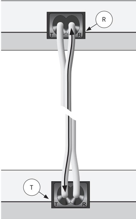
**Eine weitere Kontrolle können Sie auch über eine optische Prüfung vornehmen. Im aktiven Zustand hat sowohl der Adapter eine leuchtende Buchse als auch das Kabel ein leuchtendes Ende. Verbinden Sie jeweils den leuchtenden der beiden Ausgänge mit einem nicht leuchtenden Kabelende und den zweiten Anschluss mit dem leuchtenden Kabelende.**
