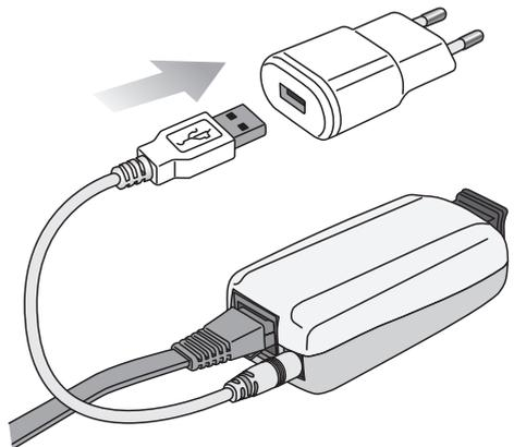
Anstatt über das mitgelieferte Steckernetzteil können die Lichtleiter-Adapter auch über den USB-Anschluss eines Computers, TV-Gerätes, einer Spielekonsole oder eines USB-Hubs, sofern diese Geräte über ein eigenes Netzteil verfügen, mit Strom versorgt werden. Der USB-Anschluss muss mindestens 500 mA Strom liefern können.
