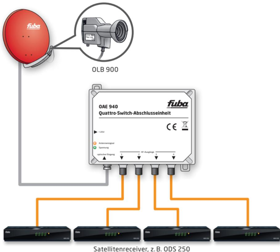
Die Abschlusseinheit wird von den angeschlossenen Receivern oder von dem optional erhältlichen Netzteil Fuba OKN 318 mit Spannung versorgt.
