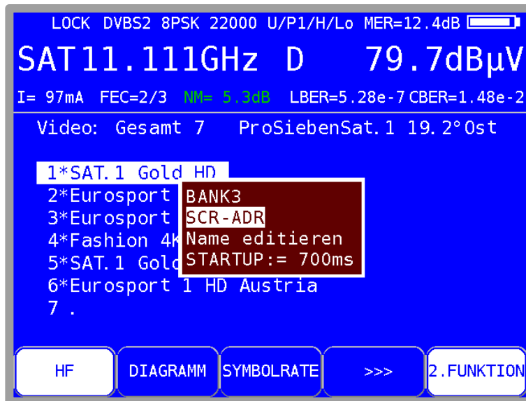
Abbildung 7-19 Startup-Zeit Unicable einstellen
