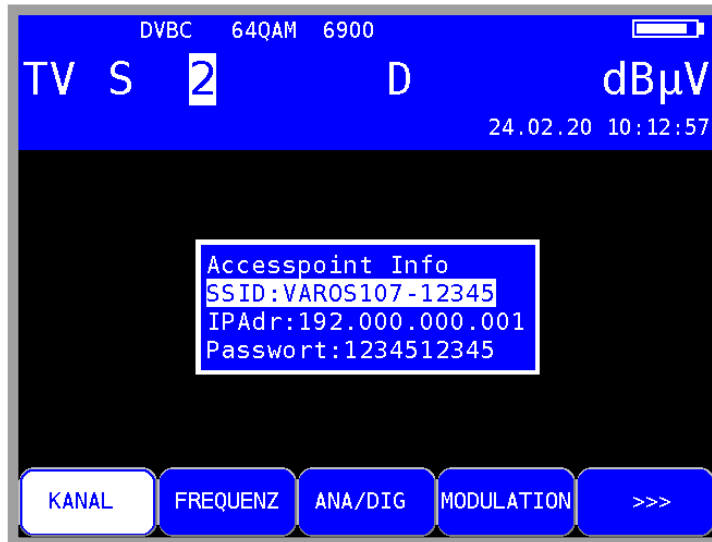
Abbildung 26-5 Access-Point Informationen nach Standardwerten
