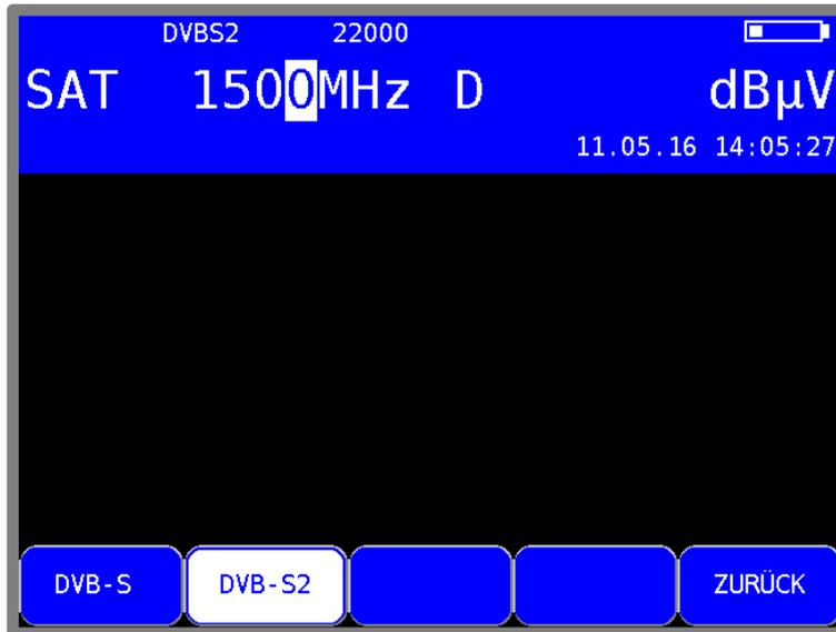
Abbildung 6-3 SAT Modulation DVB-S oder DVB-S2 einstellen
