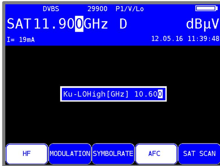
Abbildung 6-2 Eingabe Oszillatorfrequenz Ku-High-Band
