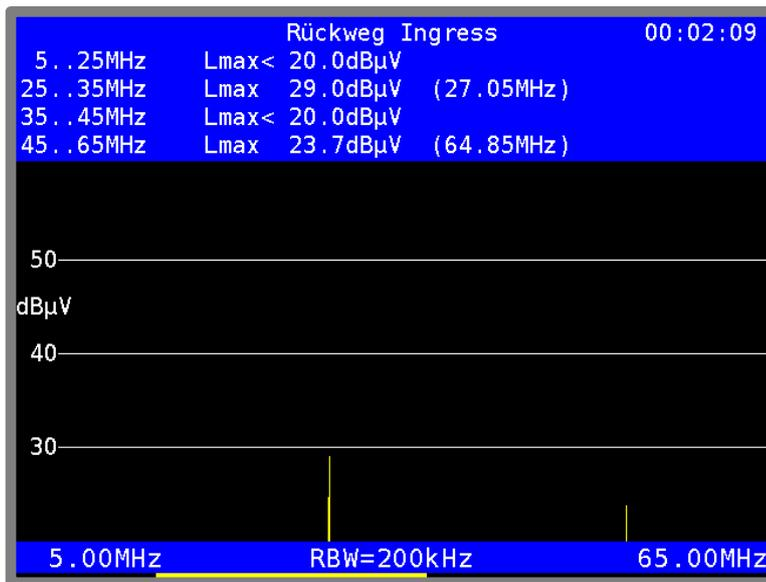
Abbildung 15-8 Spektrumanalyzer Ingressmessung
