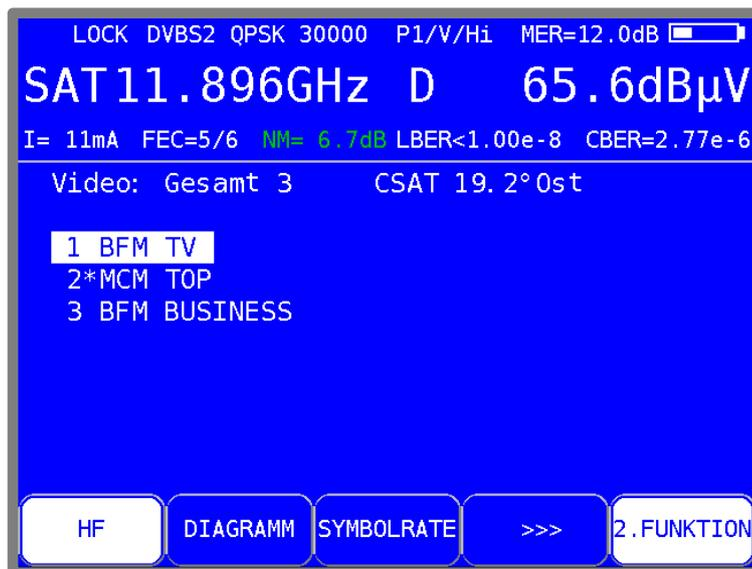
Abbildung 6-5 SAT DVB-S/S2-Parameter
