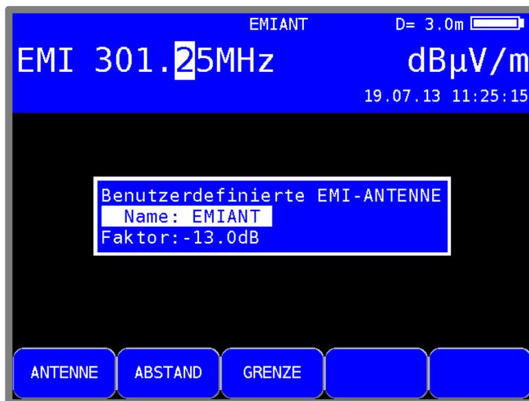
Abbildung 11-2 Störstrahl Messung Antennenauswahl
