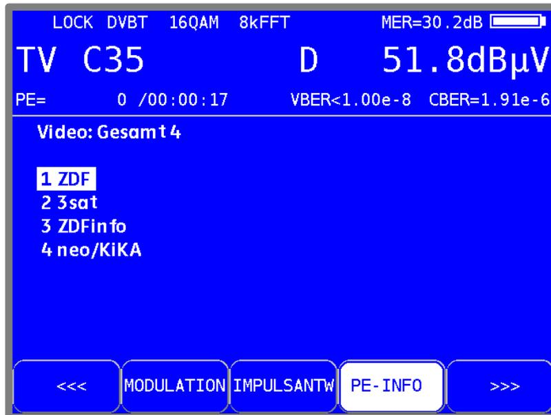
Abbildung 7-15 DVB-T PE-Messung
