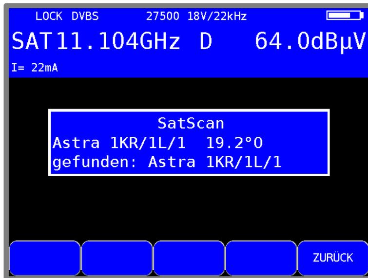
Abbildung 16-2 SAT SCAN Satellit gefunden
