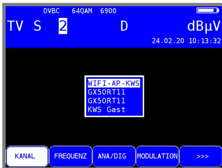
Abbildung 25-2 verfügbare Netzwerke in der Umgebung nach Netzwerk-Scan
