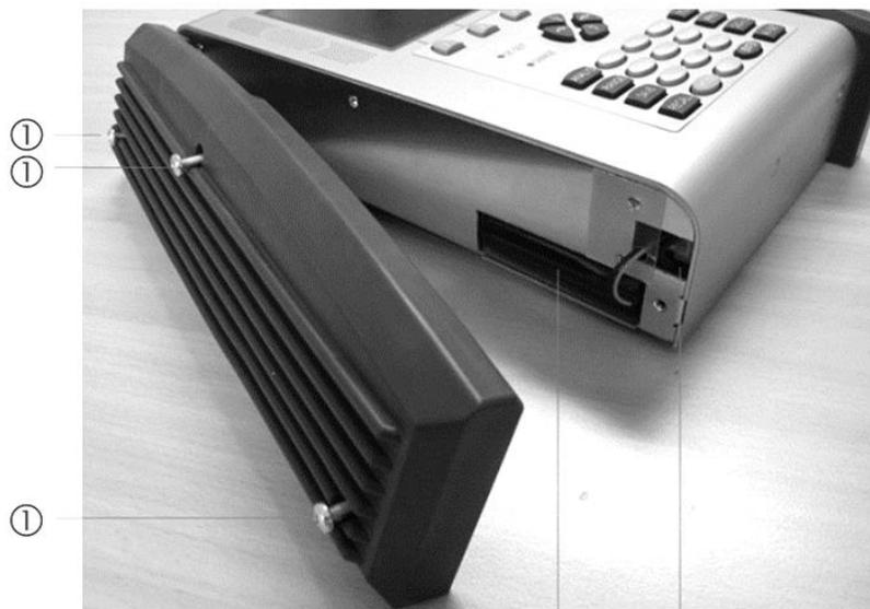
① 3 Schrauben an linkem Seitenteil entfernen und Seitenteil abziehen
