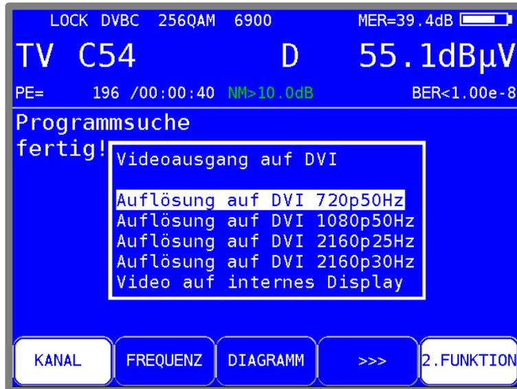
Abbildung 21-2 Videoauflösung bei HDTV über DVI Auswahlmenü
