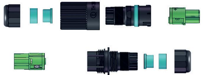
Um das Kabel der Heizmatte am Stecker zu montieren, zerlegen Sie den Stecker, indem Sie die beiden Überwurfmuttern abschrauben. Die grüne Rastnase des Steckers ist möglicherweise verankert. Drücken Sie mit einem Schraubendreher vorsichtig auf die Rastnase, um diese zu lösen.
